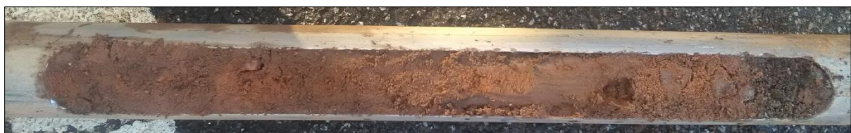
Foto 27: Erkundungsstelle FB8 – Bohrgut Kleinrammbohrung
