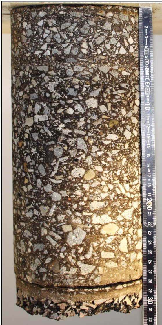
Foto 37: Erkundungsstelle FB11 – Bohrkernprobe
