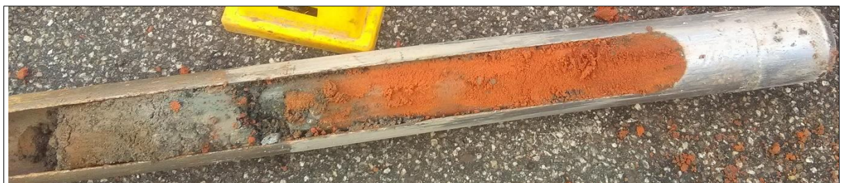
Foto 7: Erkundungsstelle FB2 – Bohrgut Kleinrammbohrung
