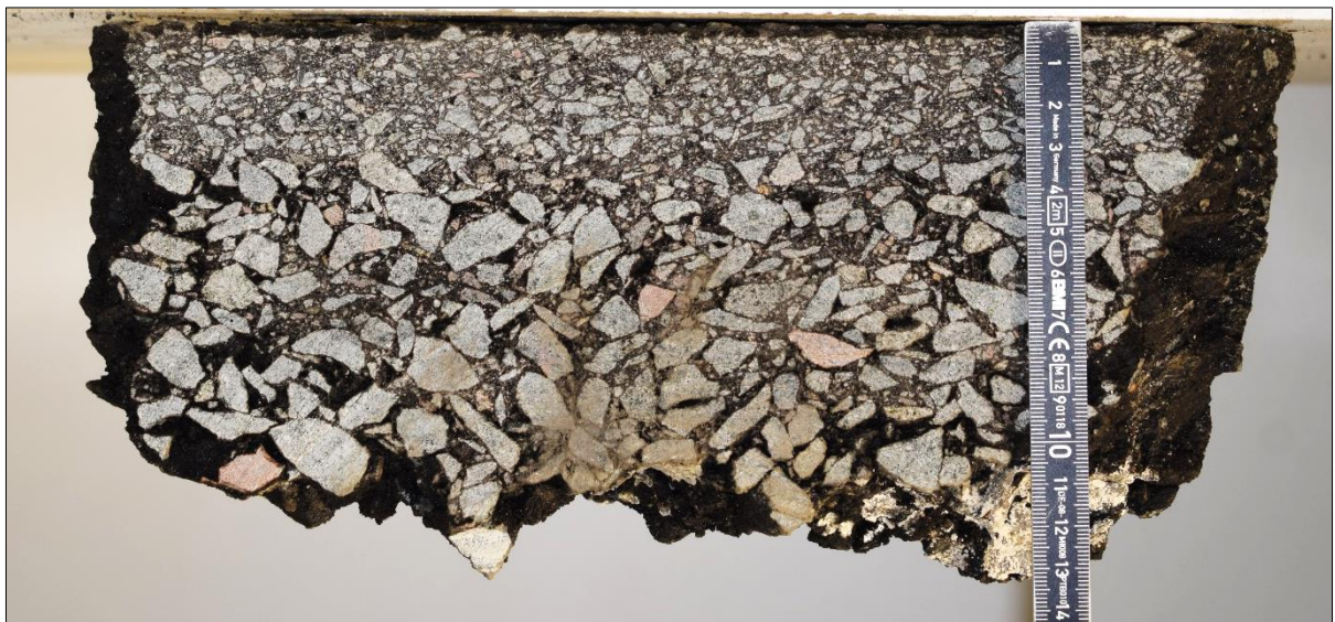
Foto 73: Erkundungsstelle FB22 – Bohrkernprobe
