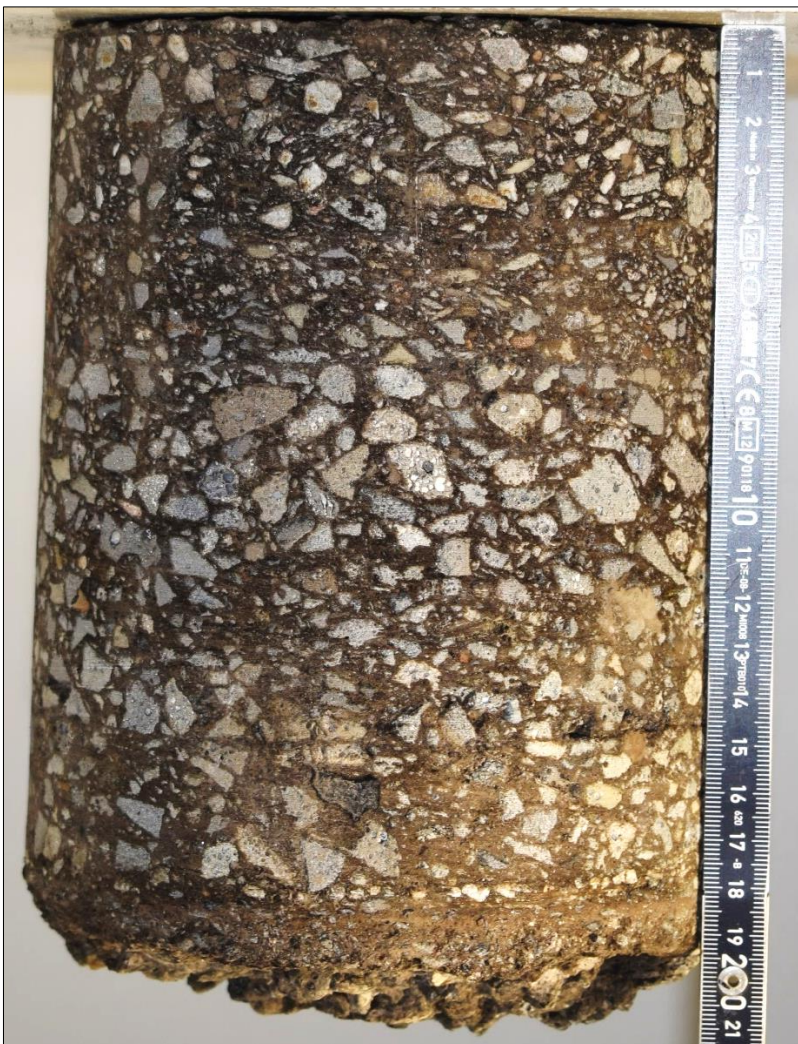
Foto 30: Erkundungsstelle FB9 – Bohrkernprobe
