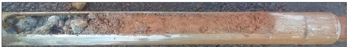
Foto 75: Erkundungsstelle FB22 – Bohrgut Kleinrammbohrung
