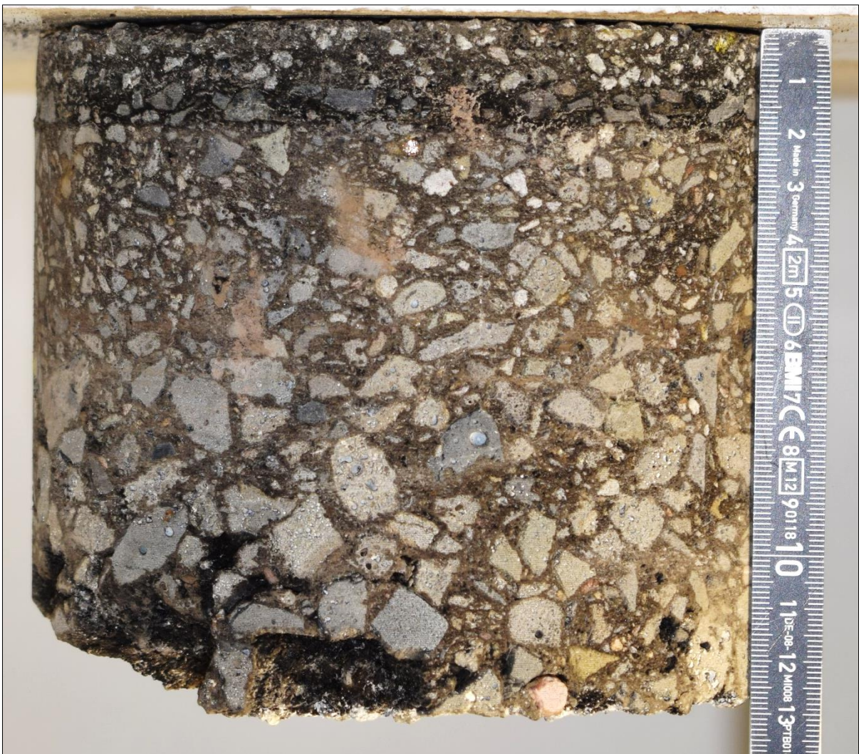
Foto 57: Erkundungsstelle FB17 – Bohrkernprobe
