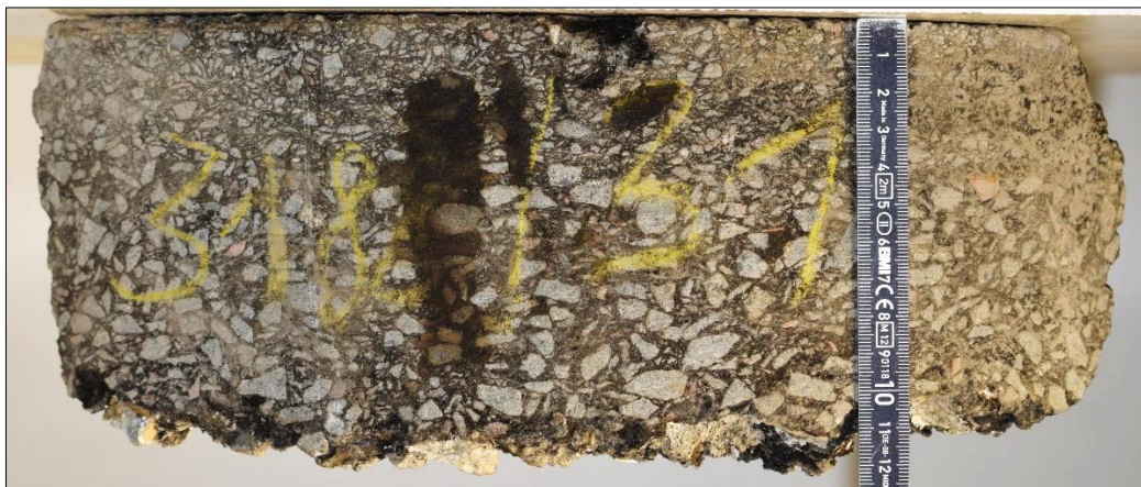
Foto 92: Erkundungsstelle FB27 – Bohrkernprobe
