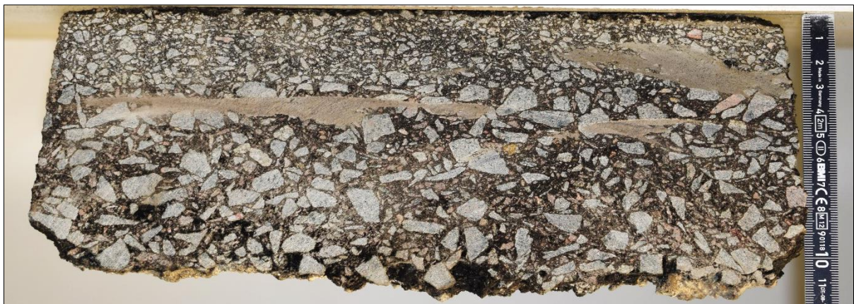
Foto 113: Erkundungsstelle FB33 – Bohrkernprobe
