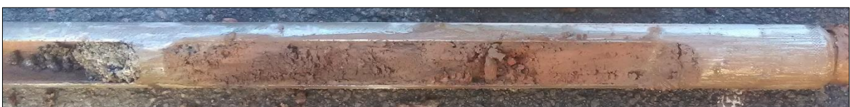
Foto 104: Erkundungsstelle FB30 – Bohrgut Kleinrammbohrung
