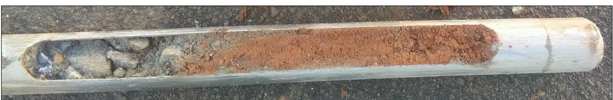
Foto 83: Erkundungsstelle FB24 – Bohrgut Kleinrammbohrung
