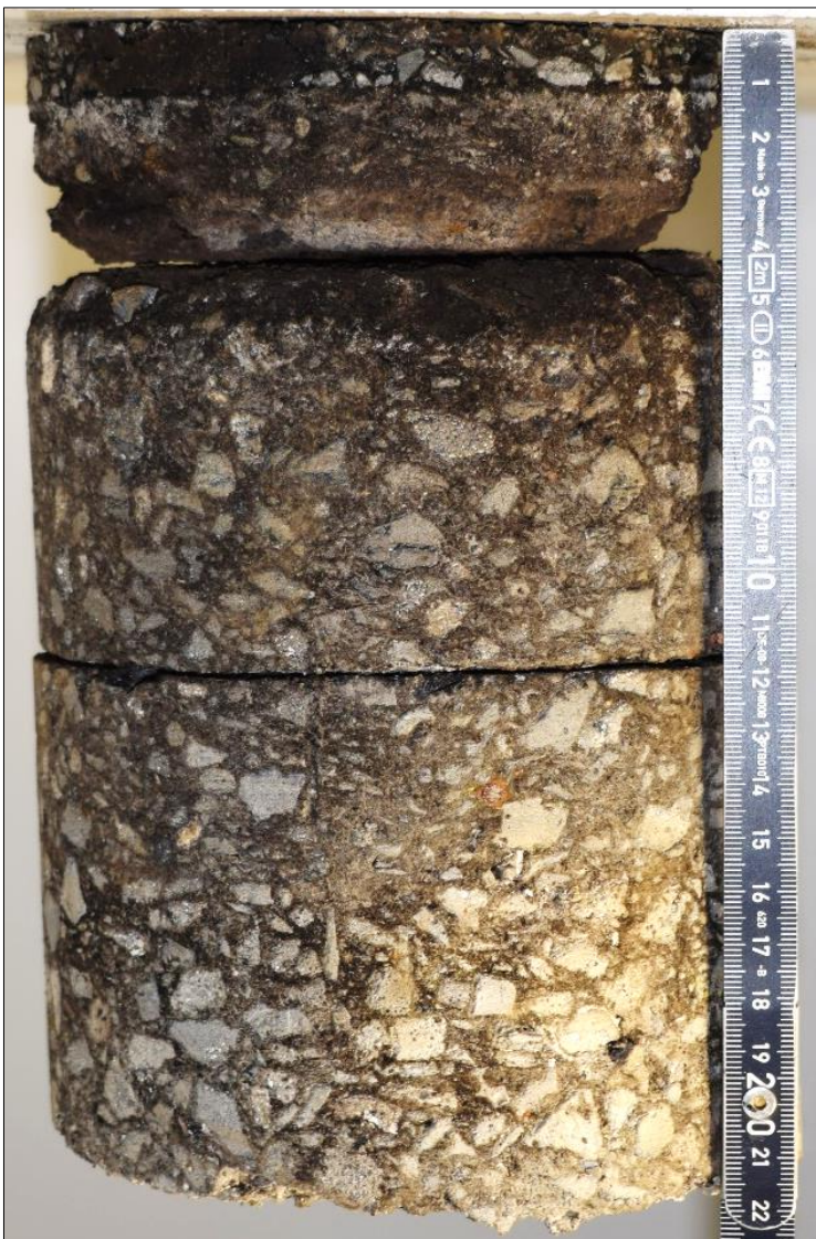
Foto 10: Erkundungsstelle FB3 – Bohrkernprobe
