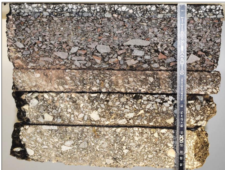
Foto 25: Erkundungsstelle FB8 – Bohrkernprobe
