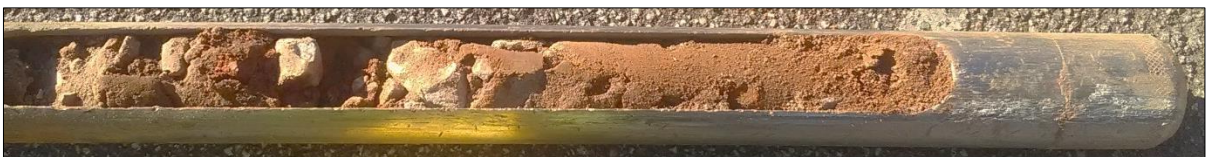
Foto 35: Erkundungsstelle FB10 – Bohrgut Kleinrammbohrung
