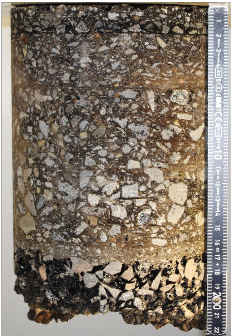
Foto 40: Erkundungsstelle FB12 – Bohrkernprobe
