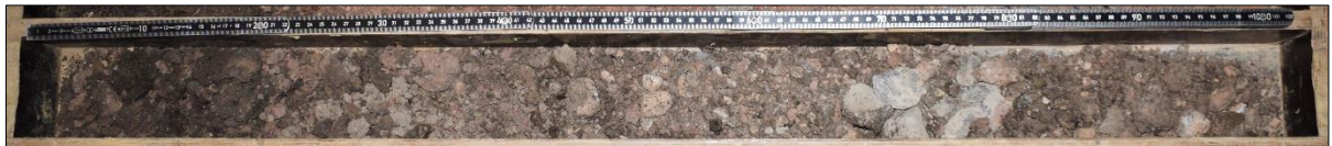
Foto 120: Erkundungsstelle BA2 – Bohrgut Kleinrammbohrung
