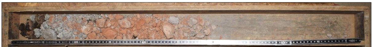
Foto 123: Erkundungsstelle BA5 – Bohrgut Kleinrammbohrung
