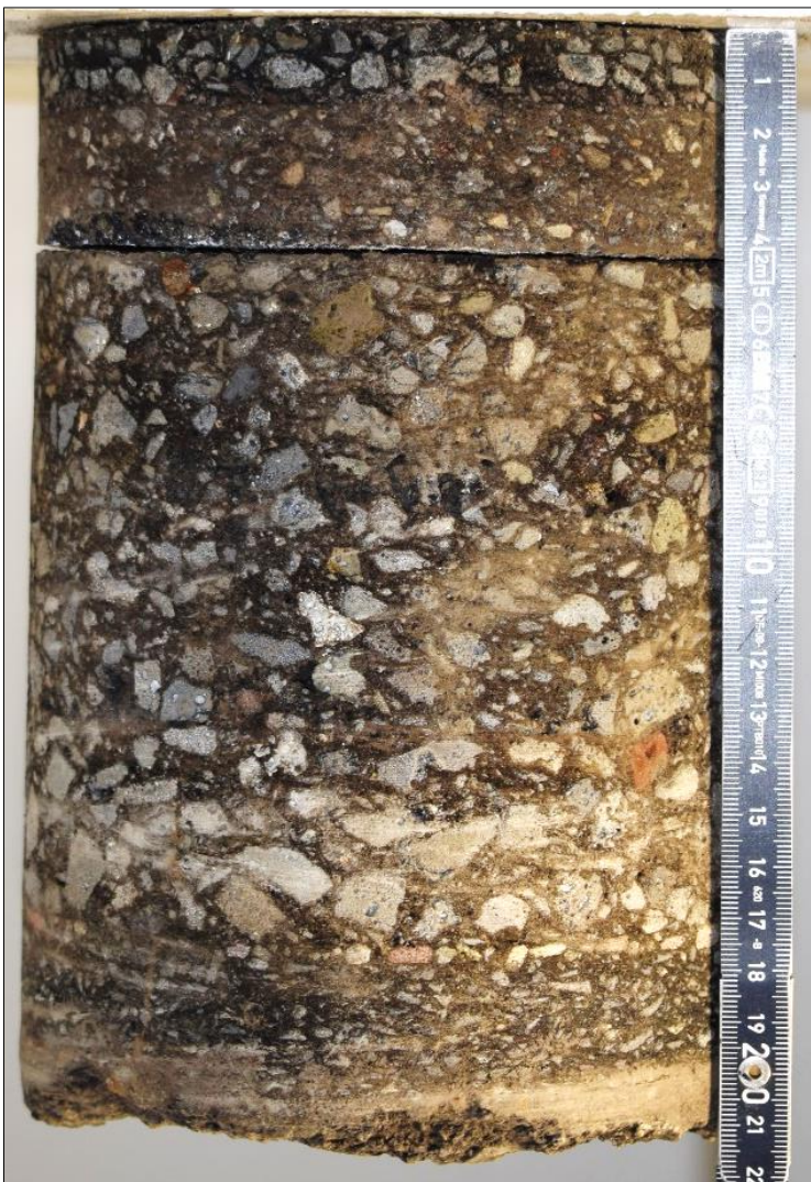
Foto 13: Erkundungsstelle FB4 – Bohrkernprobe
